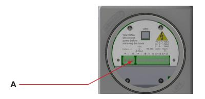
RECOMMENDED: WHEN USING DC POWER, USE A SHIELDED-TWISTED PAIR CABLE AND CONNECT THE CABLE SHIELD TO THE SHIELD EARTH GROUND TERMINAL SHOWN IN POSITION 'A' OF THE ILLUSTRATION BELOW. DO NOT CONNECT THE OTHER END OF THE SHIELD WIRE AS IT WILL CAUSE UNDESIRABLE GROUND LOOPS!
